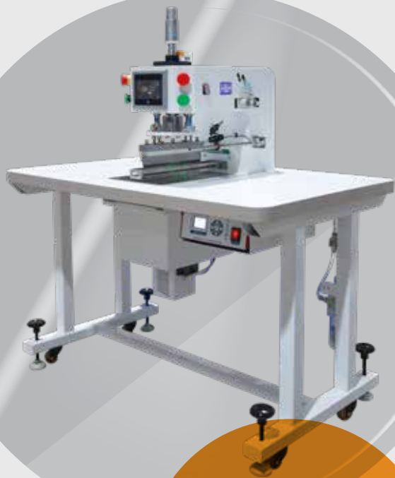
US-503 ULTRASONIC WELDING MACHINE 超聲波熔邊機
